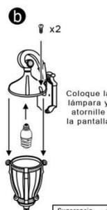
Coloque la lámpara y atornille la pantalla
