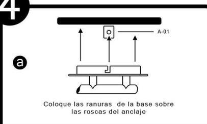
Coloque las ranuras de la base sobre las roscas del anclaje
